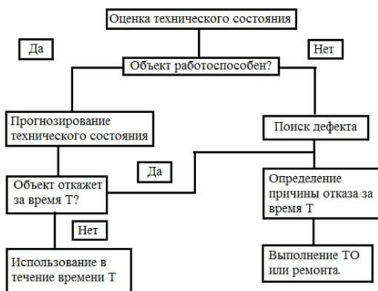
Рисунок 1 – Схема оценки технического состояния транспортного средства
